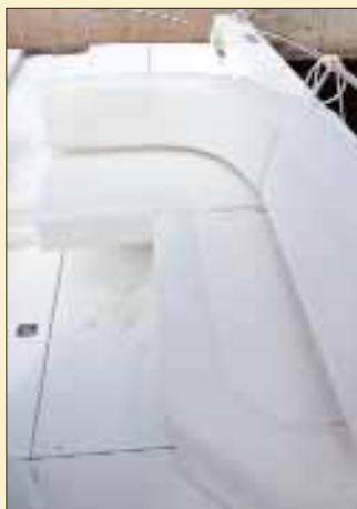
A popa de la bañera se han instalado dos asientos en forma de L, adosados a las bandas y con una capacidad de cuatro plazas cada uno.
