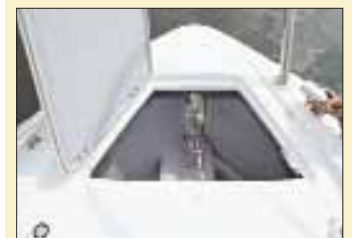
La proa termina con un alto francobordo que incorpora un escalón moldeado que nos conduce hasta el pozo de cadenas. Interiormente tiene capacidad para la instalación opcional de un molinete.
