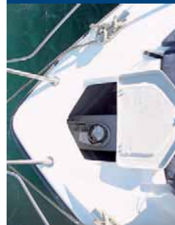
Molinete en el interior del cofre.
